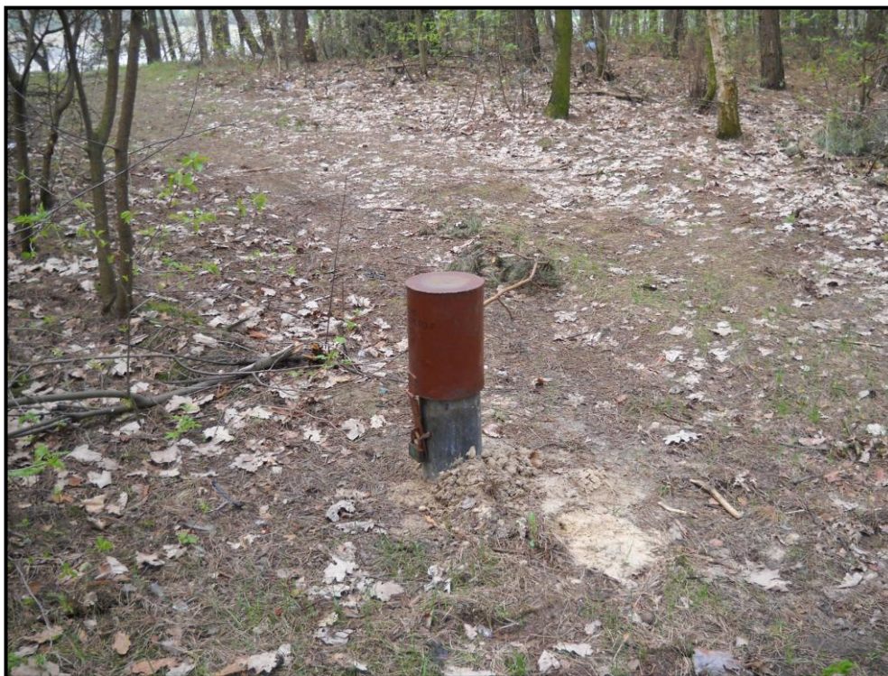
Fotografia nr 4. Piezometr monitorujący wody gruntowe na odpływie (16 kwietnia 2010r).
